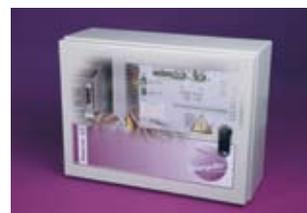
Корпус Comm. имеет терминал RS485 на 2 вывода для соединения с сетью RS485«Метацентр», гнездо RJ45 для соединения с соответствующим телефонным гнездом сети, терминал MODBUS RTU RS485 для со для соединения с сетью единения RS485 MODBUS и терминал RS232 для соединения протокола DDE ПК
